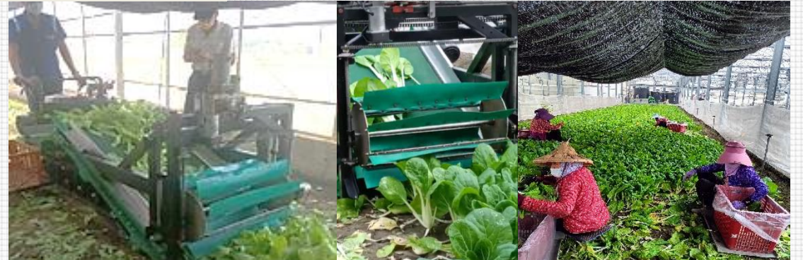
中興大學 & 晟豐公司 共同研發 短期葉菜收穫機 解決國內產業缺工迫切需求
