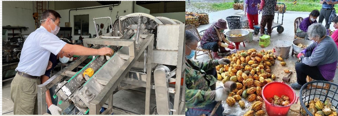
高雄區農業改良場 & 荔崇公司 共同研發 可可果實自動剖殼及果實分離機 加速可可加工關鍵步驟
