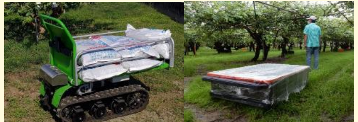
高雄區農業改良場 & 郡野公司共同研發 電動智能跟隨農地搬運機 (履帶/輪式)
