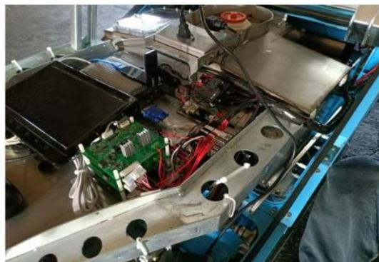
▲內部機構包含工業用控制電腦、管線及水箱
