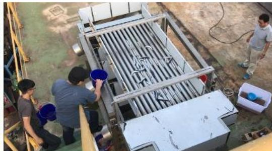
▲魚體自動化分級系統測試情形
