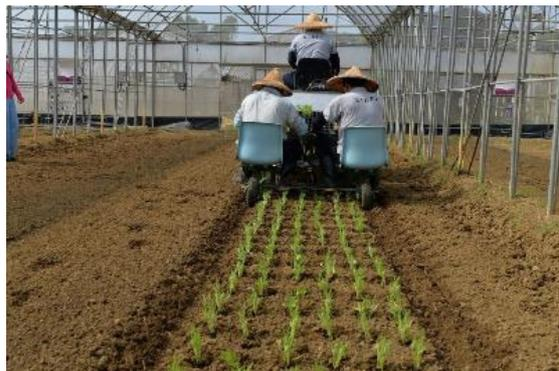
▲ 電動葉菜移植機田間作業情形
