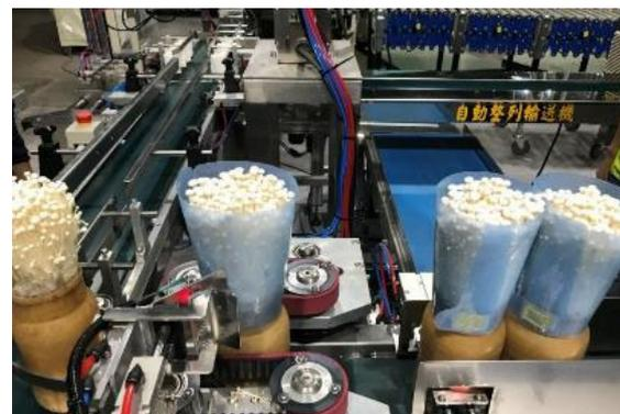
▲金針菇塑形護膜自動脫模裝置作業情形
