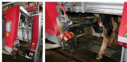
▲擠乳機器人機械手臂進行自動套杯、自動乳頭清洗等取代人力工作
