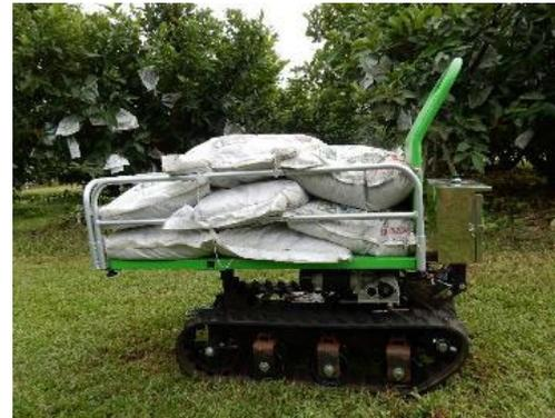
▲遙控跟隨履帶式農地搬運機搬運情形
