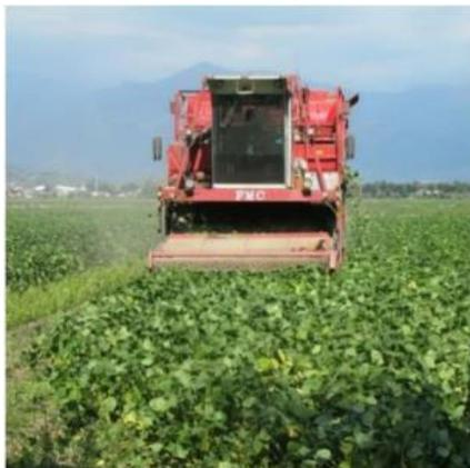
▲安裝GPS車載與影像監測系統之毛豆採收機於田間採收情形
